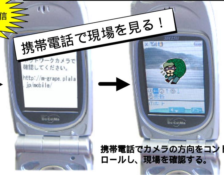
携帯電話でカメラの方向をコントロールし、現場を確認する。
